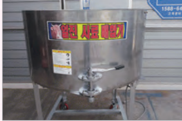
사료 배합기 เครื่องผสมอาหารสัตว์ 사료 배합기에 사료를 투입합니다. ใส่อาหารสัตว์ลงในเครื่องผสมอาหารสัตว์
